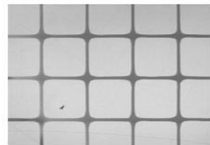
Матрица изолированных высоковольтных карманов
